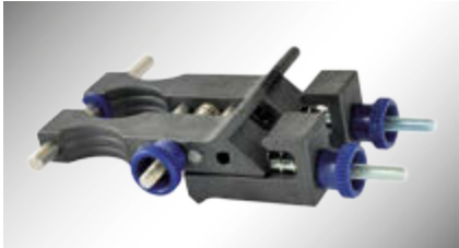
КОНДУКТОР FZ01 Для круглых ремней с диаметром до 10мм и для клиновых ремней до профиля Z/10
